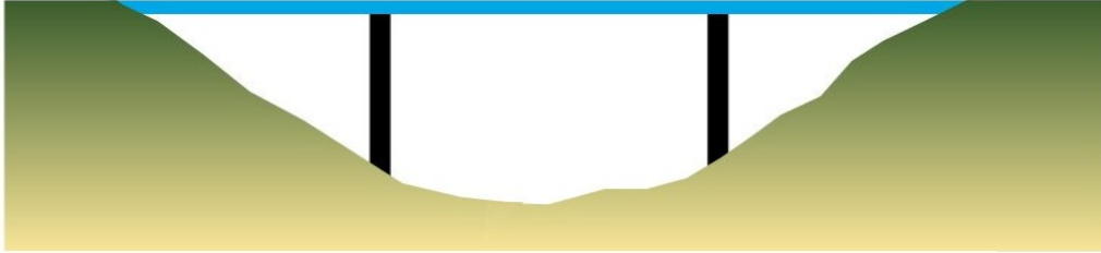
Pont à poutre
