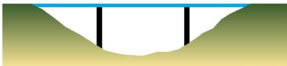
■ Pont à poutres
